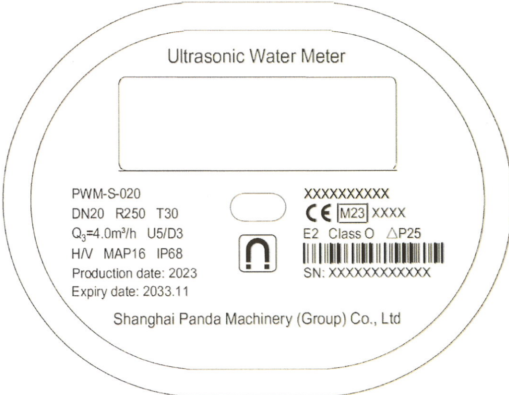
Şekil 22: PWM-S Serisi DN20 Su Sayacının Örnek Etiketi Figure 22: Label Example of PWM-S Series DN20 Water Meter
